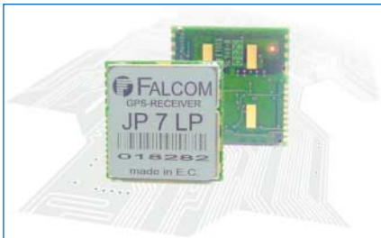
Bild 11: GPS-Empfänger JP7 von Falcom (Vertrieb: Azzurri), mit 25,4 x 25,4 x 3 mm eines der kleinsten OEM-Module.
