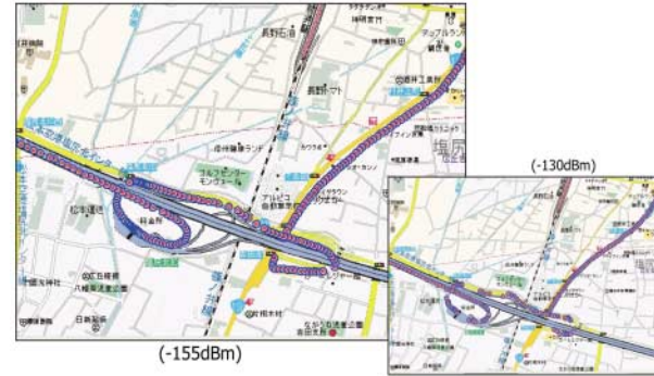
Vergleich des Satelliten-Kontaktes zwischen einem GPS-Empfänger mit -155 dBm Empfindlichkeit (große Karte) mit einem weniger empfindlichen (-130 dBm) GPS-Empfänger. Besonders nach Richtungswechsel und unter Hindernissen reißt beim -130 dBm-Empfänger der Kontakt ab. (Quelle: Epson)
